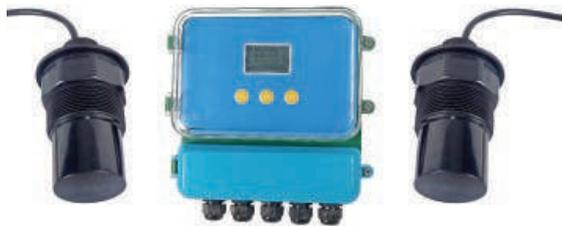
超声波液位差计，是用来测量两个不同容器的液位或者料位之间的高低差别。最常见的是在污水处理厂的进水口，测量粗格栅、细格栅前后的水位高低，计算出水位相差的高度，用来启动反捞式除污机捞出垃圾。还有在闸门前后安装，测量闸门前后的水位差，来确定开闸的时间。
