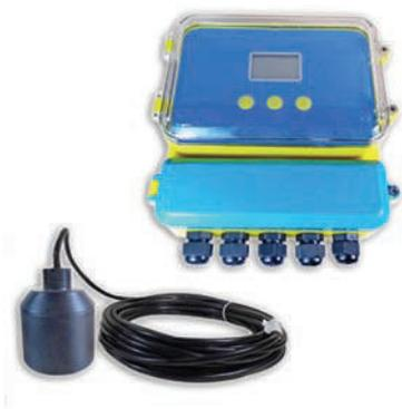
超声波泥位计又称作超声波淤泥界面仪，主要针对工业及市政领域长期可靠工作而设计。传感器浸入水中5-10cm即可工作，利用超声波发射与泥水交界面回波分析，来确定污泥层或者沉淀层的高度。
