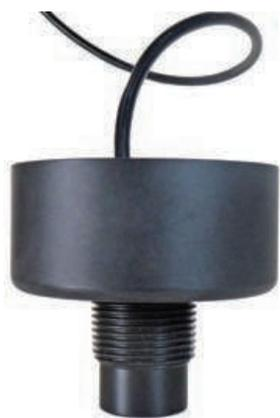
IP68超声波水位计是利用声波介质对被检测物进行非接触和无磨损的检测。主要是检测污水、河水、清水，能够测量传感器发射面到水表面的距离值。产品防护等级达到IP68水平可以在水下10米以内深度长期浸泡，不会损坏。
